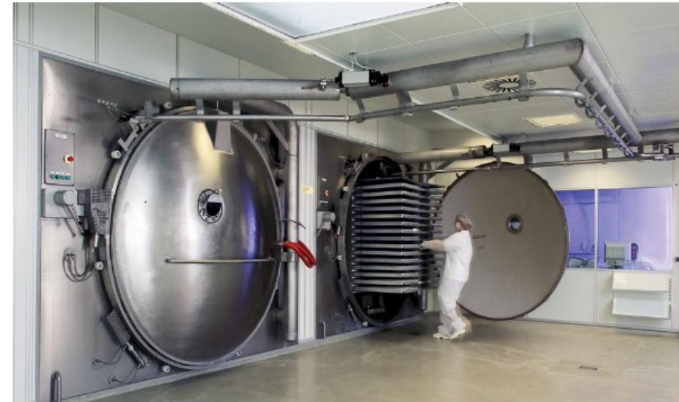
ตัวอย่างเครื่อง Freeze Dryer ในอุตสาหกรรม
